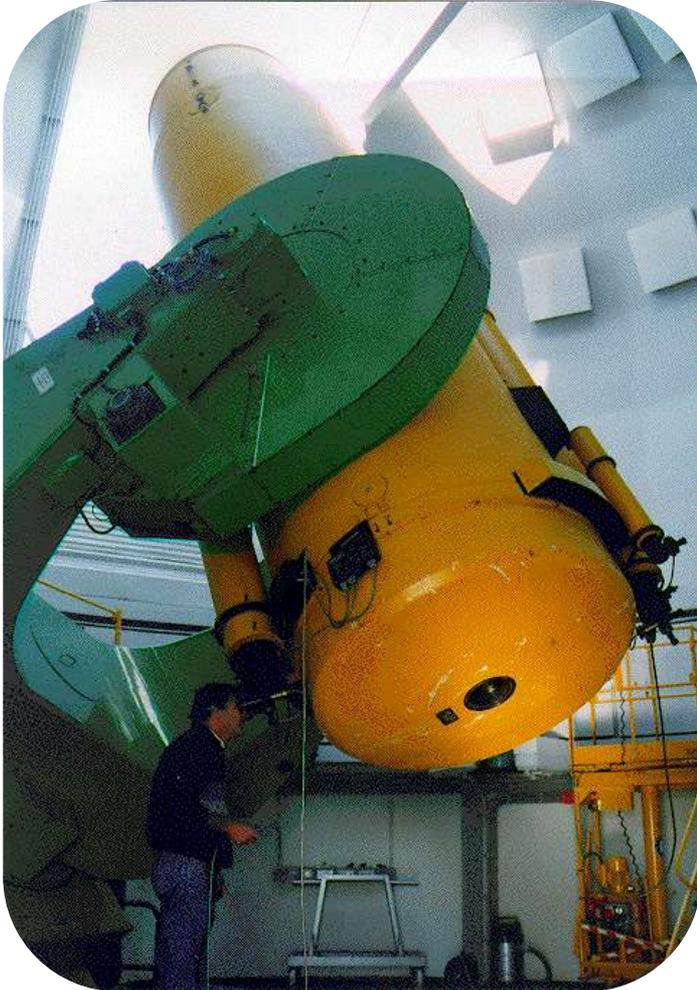
Es un telescopio de 80 cm de diámetro diseñado para tomar imágenes de amplias zonas del cielo. Se trasladó desde el observatorio de Hamburgo en 1980, donde por el clima sólo se podía usar 50-60 noches al año. Actualmente se está utilizando como un detector de basura espacial y objetos potencialmente peligrosos para la Tierra mediante la cooperación con la Agencia Espacial Europea.
